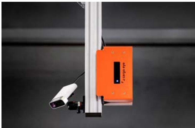
Figura 1. Cámara inteligente Cargo Eye
