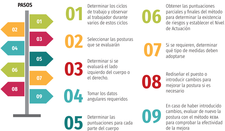
Figura 1. Secuencia de pasos para aplicación de método REBA
