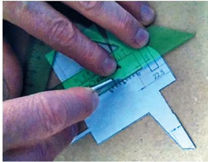
**Figura 2.** Construcción de cabeza del pie de rey
